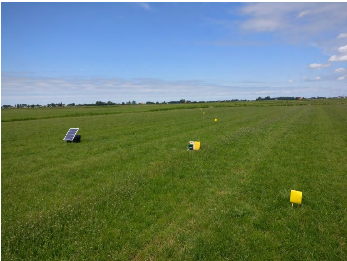
Figuur 3.25: De insectencamera (midden) met een kist met zonnepaneel waarin de accu zit voor de stroom (rechts) en een transect van plakstrips.
