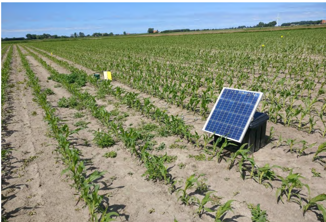
Figuur 3.27: Om geen effecten van het zonnepaneel op de resultaten te hebben is de insectencamera op afstand geplaatst en met een kabel verbonden aan de kist waarin ook de accu.
